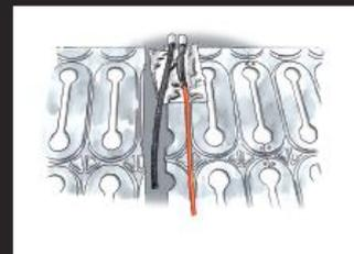
7) Vérifiez que les plaques ne soient pas recouvertes de copeaux de métal. Si c'est la cas, aspirez-les pour éviter tout dommage sur le câble.
